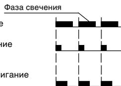
Если мигающий сигнал кнопочного выключателя погас, то приемник запрограммирован на **данный** передатчик и **данным** передатчиком отопитель может быть дистанционно включен или выключен.
